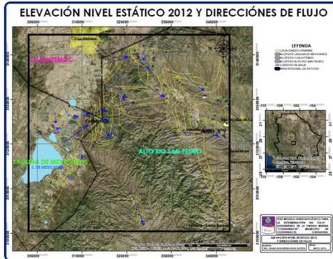
Figura 5. Elevación nivel estático 2012 y direcciones de flujo.
